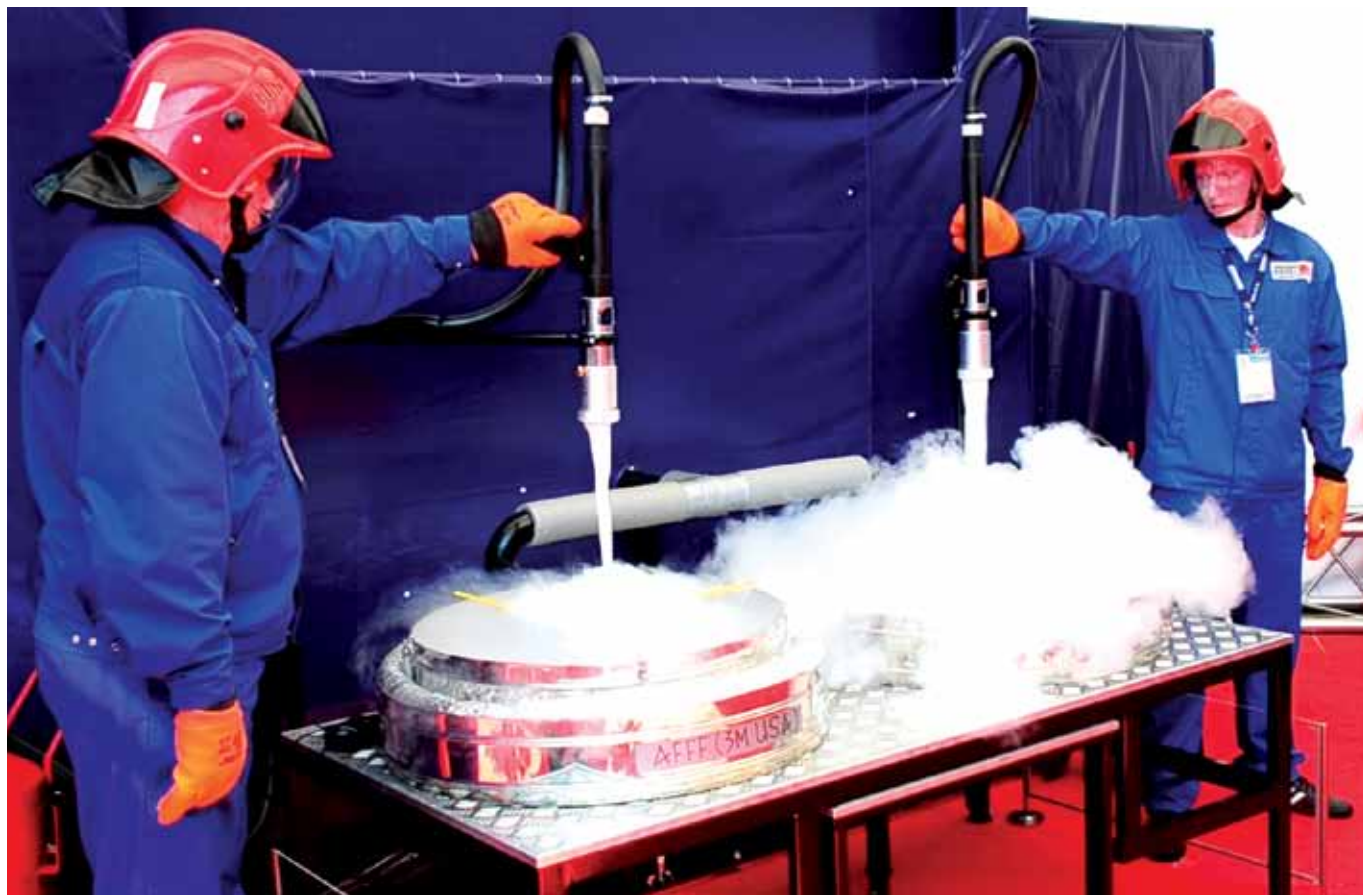
▲ Демонстрация поведения огнетушащих пен на поверхности СПГ.
