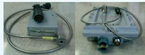
Датчики вибрации трёхкоординатные ДВА-ИЗ
