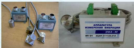
Аппаратура измерения вибрации ИВА-И, ИВА-М
