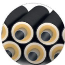
Трубы с комбинированной изоляцией для строительства магистральных нефте- и газопроводов, также технологических трубопроводов, транспортирующих высокотемпературную среду до +250 °C. Состоят из базальтового волокна и пенополиуретана.
