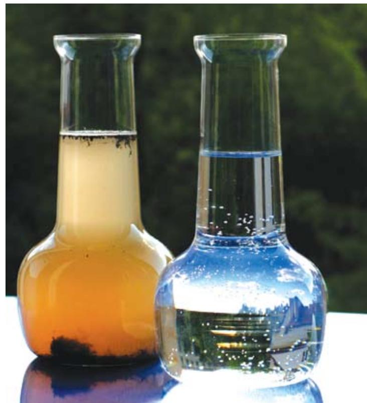
**Рис. 2:** Результаты технологического процесса разделения водонефтяной эмульсии
