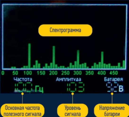
Основное окно на индикаторе занимает спектrogramма полезного сигнала. Также на индикаторе отображаются уровень сигнала, основная частота, напряжение встроенной батареи аккумуляторов. Вид спектrogramмы, уровень и основная частота полезного сигнала позволяют судить о наличии разрядов и природе их возникновения. По напряжению батареи аккумуляторов контролируют степень ее разрядки.
