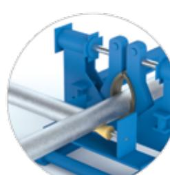
Полевой способ подготовки концов трубопроводов в виде раstra и конуса. Сборка производится с применением оборудования «Батлер».
