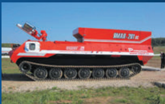
Мобильная насосная станция «Ямал-201» на базе МТ-Лбу
