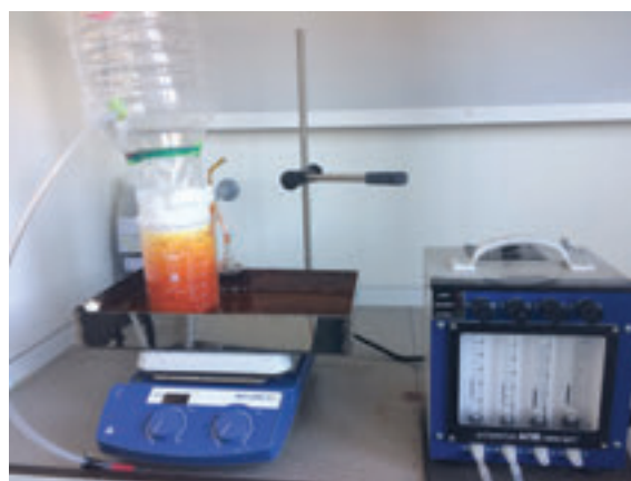
Фото 6: Измерения концентраций паров брома над слоем пены СДКП (при температуре брома до 40°C)
