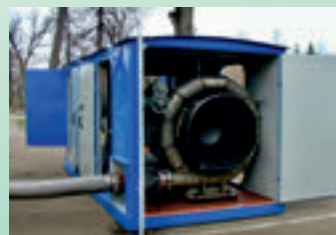
Газотурбинная компрессорная установка ГТКУ М10/21
