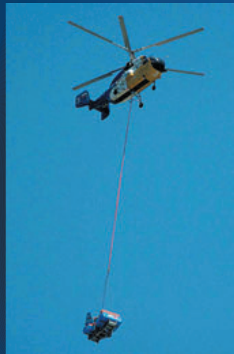
Вертолетное водосливное устройство с УКТП «Пурга» 30x2 на внешней подвеске вертолета КА-32
