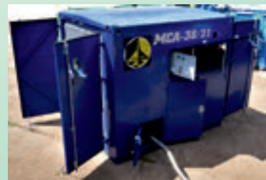
Газоразделительный блок мобильной азотной установки МСА-38/21
