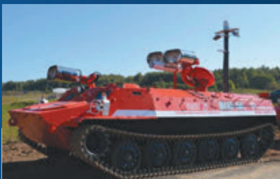
Гусеничная пожарная машина «Ямал-150» с УКТП «Пурга-30» и УКТП «Пурга-150» с дистанционным управлением и системой видеонаблюдения
